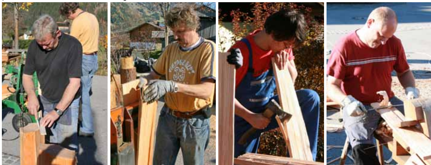
V.l.: Christian Brugger zeichnet an, ob auf's Brett oder auf die Daube gekloben wird; Anton Brugger am hydraulischen Spalter; Alexander Lottersberger putzt die Schindeln mit dem Handbeil und Michael Mattersberger putzt mit dem Roafmesser nach.
