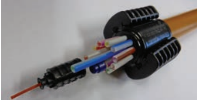
Für bestehende Siedlungen könnte bereits ein gebündeltes LWL-Kabel mit den einzelnen Leerrohren verlegt werden. Die Kosten belaufen sich auf ca. € 12,00 pro lfm. Dabei wird nachträglich nur mehr das Glasfaserkabel eingeblasen.
