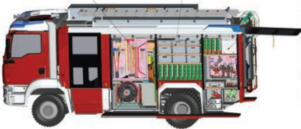
Beladungs-Skizze: Übersicht der Beladung der linken (Fahrer-)Seite des bestellten TLF
