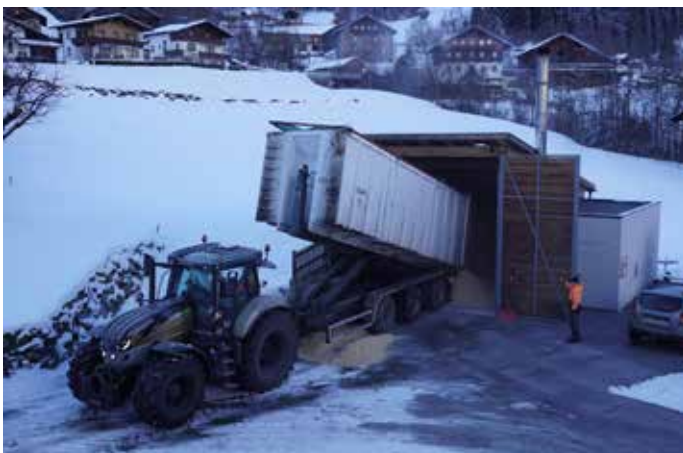
Das Hackgut für die Biomasse-Nahwärme stammt von der Firma Unterrainer in Ainet und ist ausgezeichnete trockene Qualität. Mit der Lieferung ist die Firma Gumpitsch beauftragt. Eine Mulde fasst 50 Kubikmeter Hackgut.
