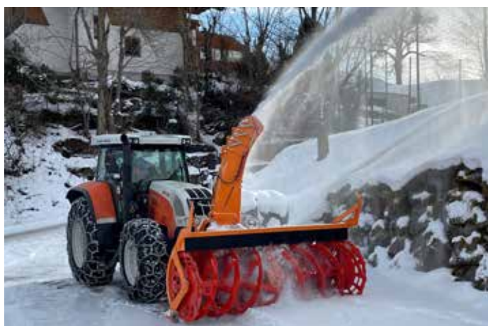
Im Oktober wurde eine neue Kahlbacher Frässhleuder für die Gemeinde geliefert. Kostenpunkt € 51.600,00 inkl. MWSt. Das Land hat dafür eine Bedarfszuweisung in Höhe von € 43.000,00 gewährt. Räumbreite = 2800 mm, Frästrommeldurchmesser 950 mm, Räumhöhe bis ca. 1300 mm, Wurfweite bis ca. 30 Meter;
