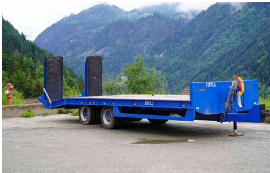
Der Tandem-Tieflader ist in der Zwischenzeit adaptiert und unverzichtbar geworden. Mit dem An- und Abtransport von einer Baustelle zur nächsten wird auch der Bagger wesentlich mehr geschont (Gummiketten und Endantrieb).
