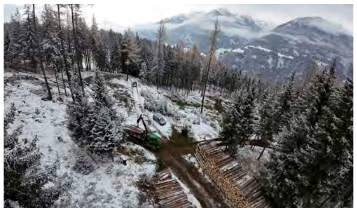
Plattner Stalle (außerhalb vom Guten Hirten bzw. Banklboden) Mit dem Harvester wird der Bestand geschnitten und der Forwarder übernimmt die Rückung zum Forstweg. Die Bezeichnung „Schlägerung und Lieferung“ ist nur mehr zum Teil zutreffend. Drohnenaufnahme von Ing. Thomas Gradnig (Förster - Bezirksforstinspektion Lienz). Unsere alten Holzknechte würden so viel Technik nicht mehr verstehen - ohne Muselbeil, Zugsäge, Schöpser, Zapin, usw.
